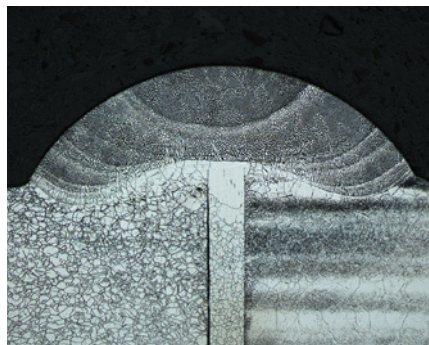
Section polie mécaniquement et attaquée électrolytiquement dans une soudure par gaz inerte de tungstène par micropulsion dans de l'alliage Inconel 625. Après attaque à l'acide oxalique 10%; 10 Volts pendant 10 s. Fond clair, 2,5x.
