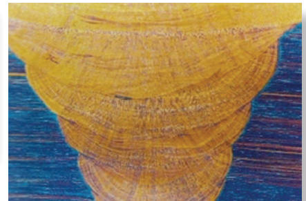
Section polie et attaquée à travers un soudage en plusieurs passes d'un acier inoxydable austénitique. Après une attaque colorante selon Lichtenberger et Bloech. Fond clair, 6,5x.
