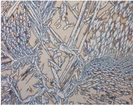
Même matériau. La microstructure de la soudure consiste principalement de ferrite delta et d'austénite. Fond clair, 200x.
