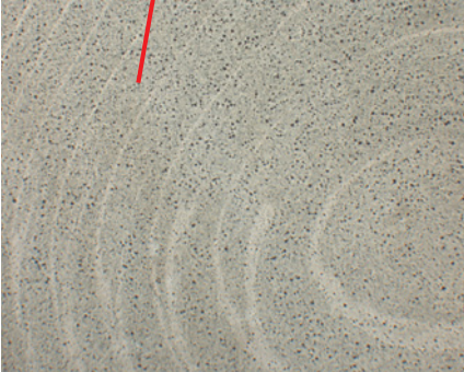
Aluminium soudé par friction malaxage, après attaque externe selon Barker, utilisant 15V pendant 3 mn. En lumière polarisée avec une lame teinte sensible (plaque λ1/4), 25x
