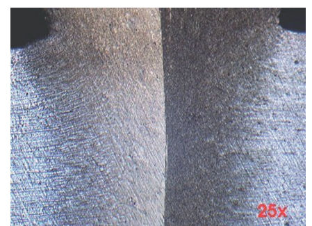
Fig. 3: Interface de fusion sur un alliage d'acier faiblement allié soudé par friction linéaire sous pression, montrant une zone affectée thermiquement et une déformation plastique associée. Fond clair, 25x.
