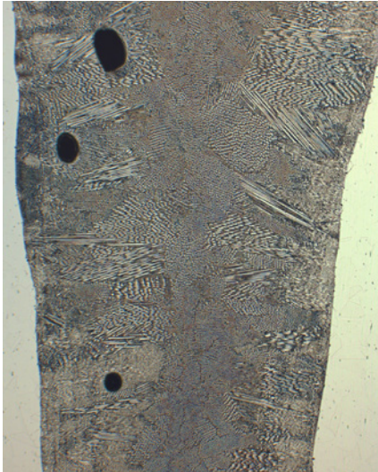
Section transversale d'un alliage à base de nickel soudé par faisceau d'électrons, montrant une microstructure basaltique soudée avec quelques bulles diffusées. Fond clair, 50x.
