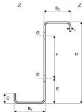
Les profils à froid en Z en particulier possèdent l'avantage d'être emboîtables, ce qui permet de résoudre efficacement le problème de la continuité sur appui. La distance de recouvrement varie en fonction des charges et des conditions des flèches.
