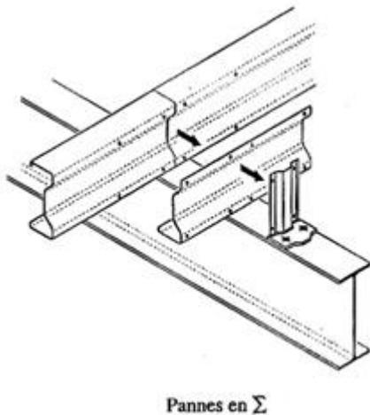
L'éclissage permet de réaliser la continuité des pannes et par la même occasion un abattement du moment sur appui. Les éclisses sont généralement profilées à froid, comme les pannes, mais à partir de tôles d'acier plus épaisses de l'ordre de 4mm. Compte tenu de la forme de la section des pannes, l'éclissage est placé d'un seul côté, avec des boulons au simple cisaillement.
