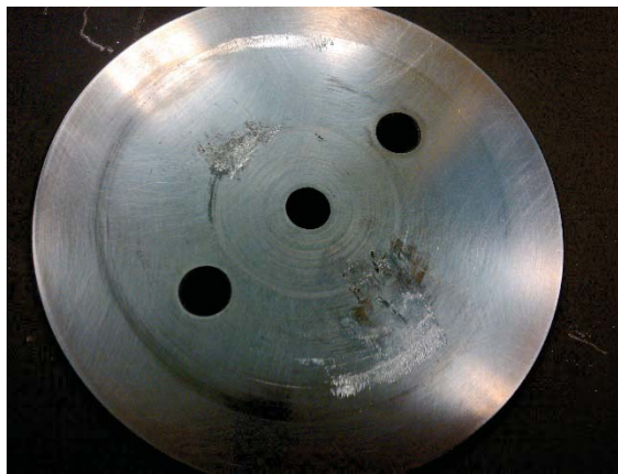
Figure 2.26. Phénomène de matage de la masse inertielle
