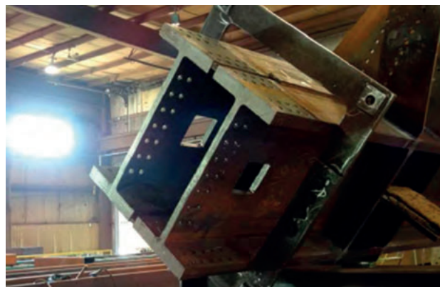
Deux profilés soudés ensemble Two heavy sections welded together Zwei zusammengeschnittene Profile
